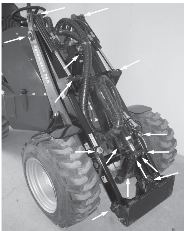
Bilde 13 Smørepunkter på løftbom med parallellføring
