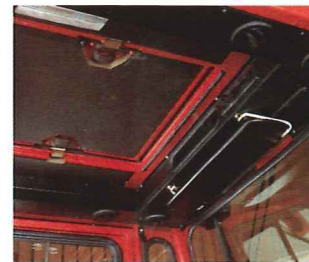
Radiohylla med inbyggda ventilationskanaler ger imfria rutor.
