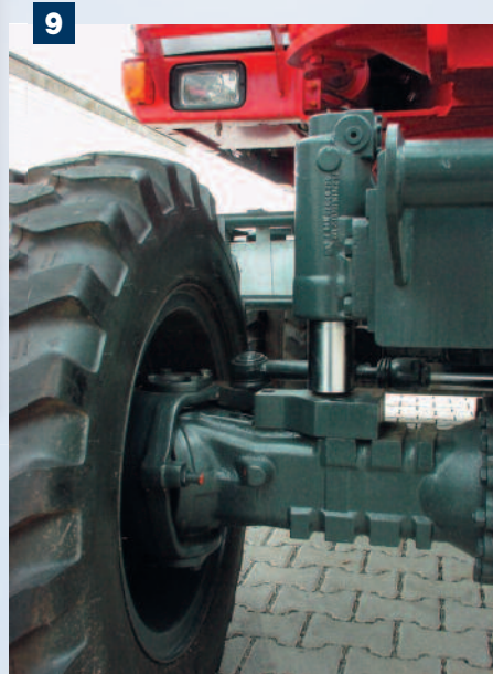
Lenkachse ist als Pendelachse ausgelegt die hydraulisch blockiert werden kann
